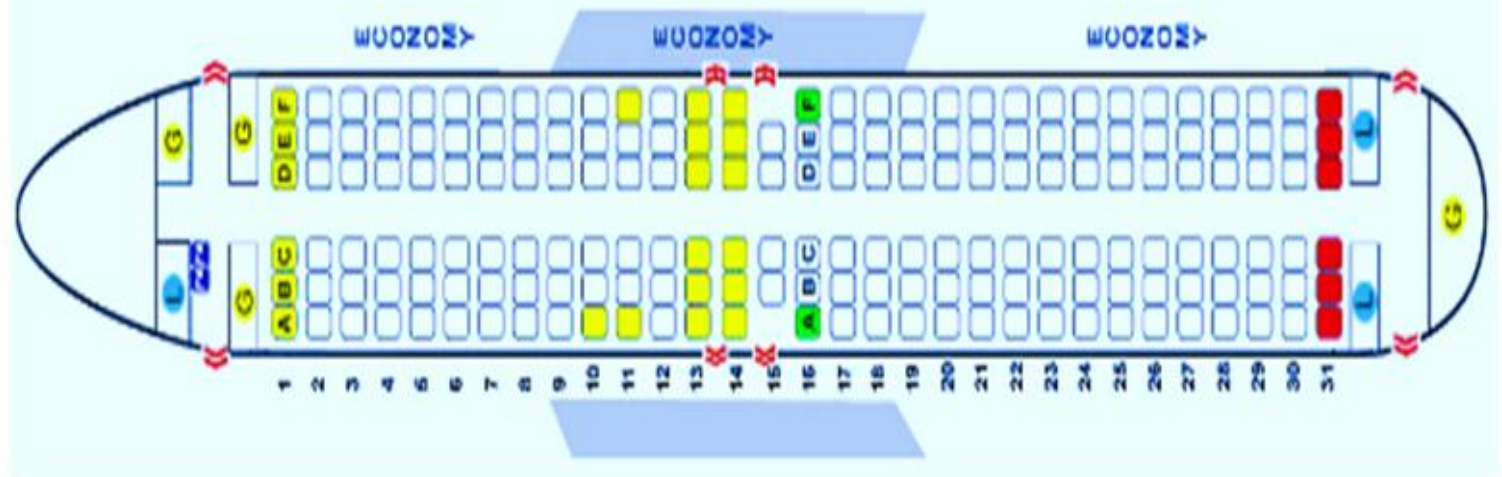
ნახაზი N 2.20 Boeing 737-800-ის სამგზავრო სალონის სქემა: ა) ბიზნეს/ეკონომ კლასი, ბ) ეკონომ კლასი [61,68,76]
